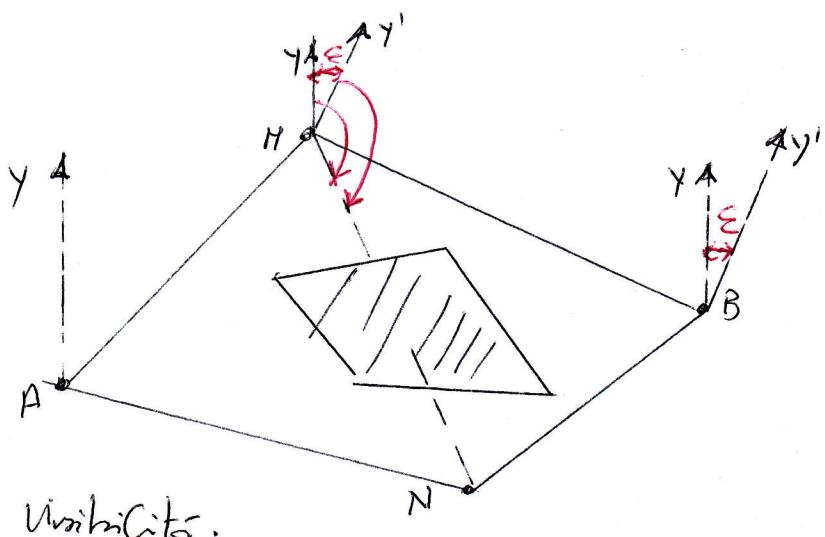
le due stazioni da collegare sono separate da un ostacolo che ne impedisce la raggiunta
