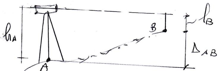
il dislivello  $\Delta_{AB} = h_A - h_B$ . E' un metodo presto che si impiega quando non sono richieste elevate precisioni in quanto ci possono essere errori maggiori dovuti alla non perfetta orizzontalità del cannone che viene dato alla misurazione dell'altezza fra strumenti. Per maggiori precisioni si utilizza la livellazione del mezzo, ponendosi lo strumento in mezzo e puntando su entrambi i punti A e B col effettuando le letture in A e in B.
